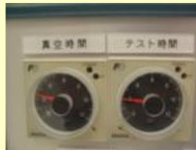
設定した真空圧になるよう真空時間を設定します。また、テストする時間を設定します。
