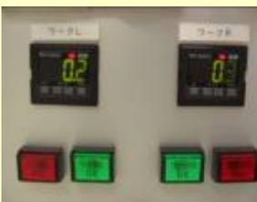
テスト圧力を設定します。まず、真空中に至る圧力を設定し、リーク圧力(密閉後の漏れ圧)を設定します。
