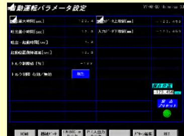
サーボモーターの最大速度、トルクリミットなどの設定が可能
